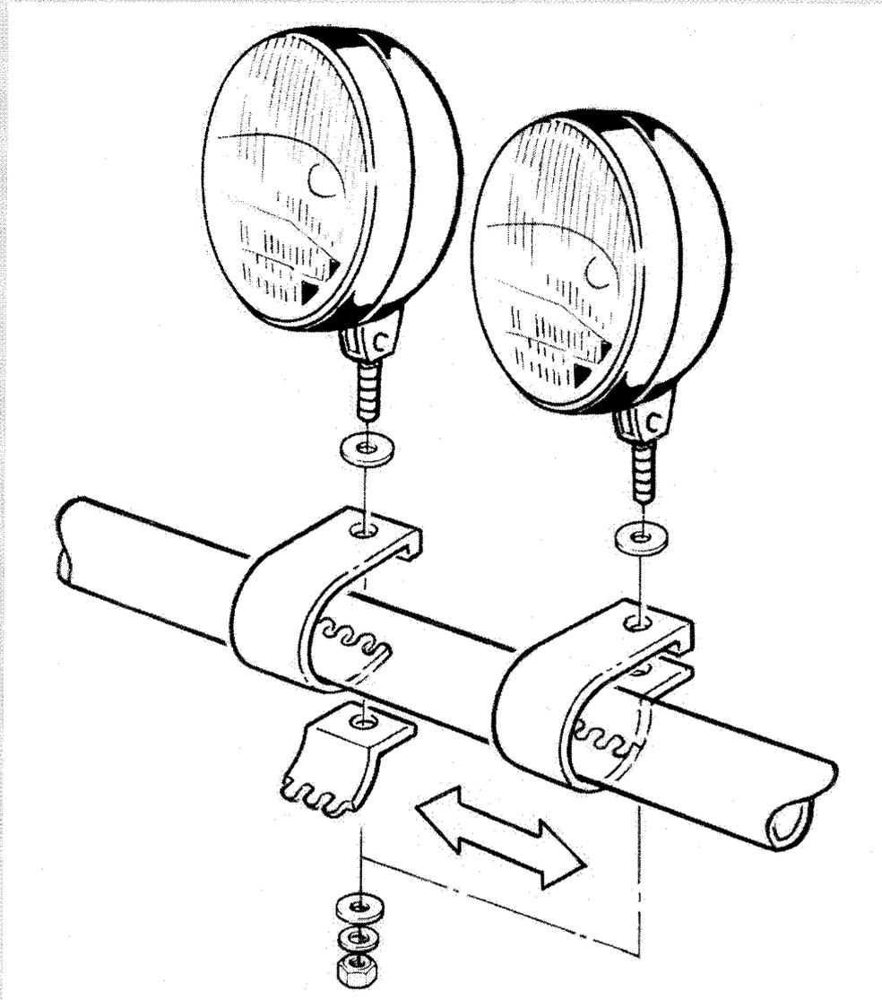
**Normteile für : Ø 42, Ø51, Ø60, Ø70, Ø76***Bezeichnung, Größe, Ausführungsart*
